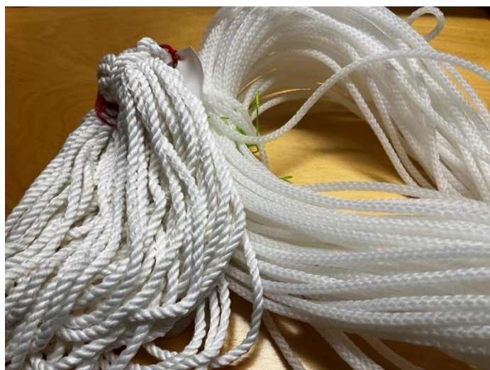
Bilde 8. Småskala tau til degraderingsforsøk, 3 slått multifilament myk type (venstre) og flettet monofilament stiv type (høyre).
