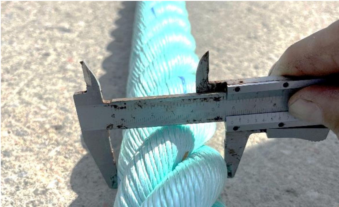
Bilde 2. Tykkelsen på snurrevadtauene viste 58 mm ved måling med skyvelære før de ble tatt ombord.
