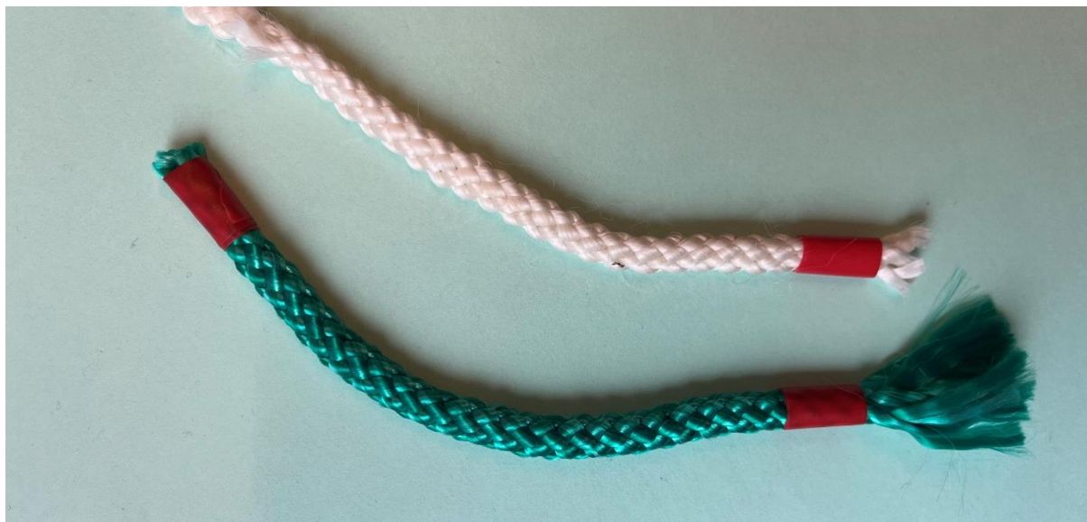
Bilde 9: Småskala tau multifilament flettet bionedbrytbar øverst og vanlig flettet Danline nederst.
