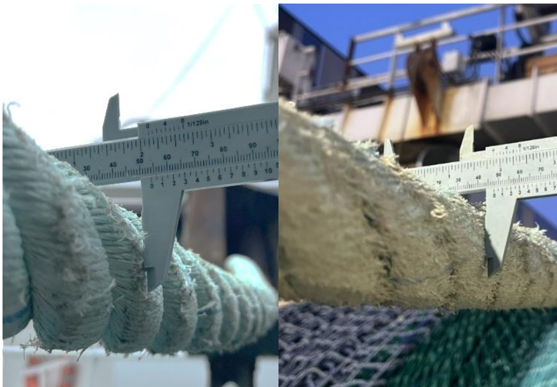
Bilde 11. 2. oktober 2024 måles tauene en diameter på 54 mm, en nedgang på 4 mm på 21 blåkveitehal (venstre bilde). Per desember 2025 er snitt dimensjon på 48,5 (høyre bilde)
