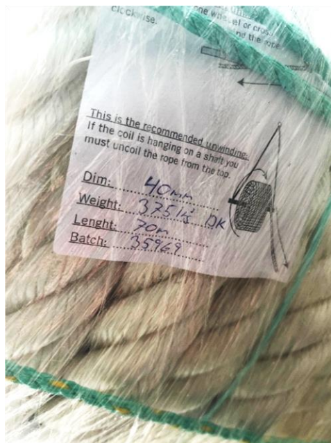
Bilde 5. Nedbrytbart snurrevadttau (hvitt) og vanlig snurrevadttau (grønt). Til høyre sees spesifikasjoner på tauet (40 mm diameter, 375 kg per kveil, 70 meter lengde, Batch nr. 35969).
