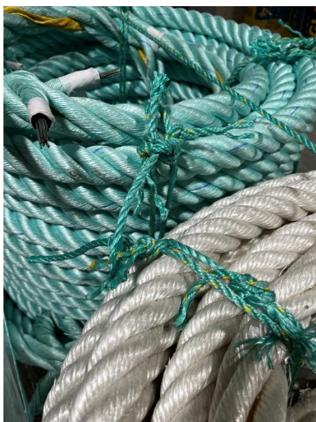
Bilde 5. Nedbrytbart snurrevadttau (hvitt) og vanlig snurrevadttau (grønt). Til høyre sees spesifikasjoner på tauet (40 mm diameter, 375 kg per kveil, 70 meter lengde, Batch nr. 35969).
