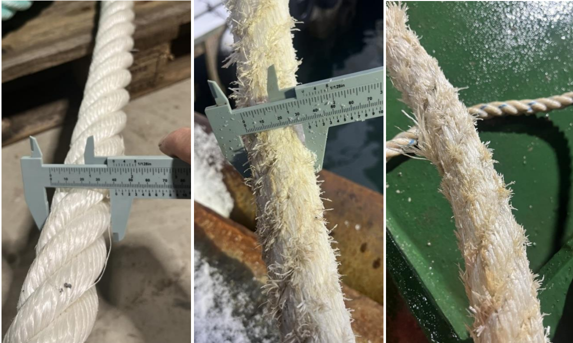
Bilde 12. Slitasje i nedbrytbar snurrevadtuet over tid. Venstre bilde: september 2025 før det tas om bord. Midterst bilde: 1 desember 2025 (5-6 m framfor børtreet). Høyre bilde: 1 desember 2025 2 m framfor børtreet.
