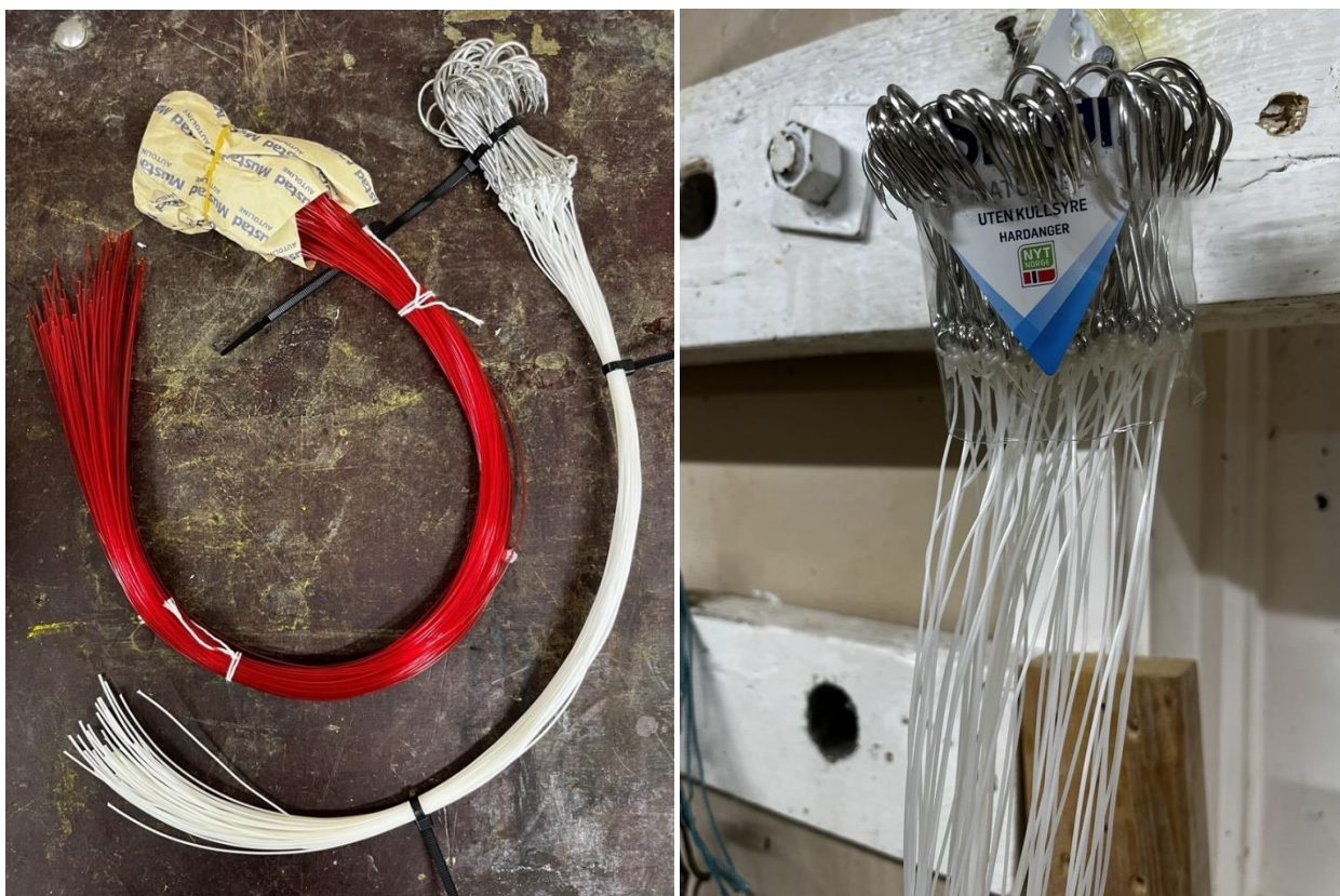
Bilde 3: Bionedbrytbart monofilament levert av Norner, ferdig knytt som forsyn. Legg merke til manglende krøll på disse materialer, kontra PBSA. Tilnærmet likt nylon (rødt, venstre).
