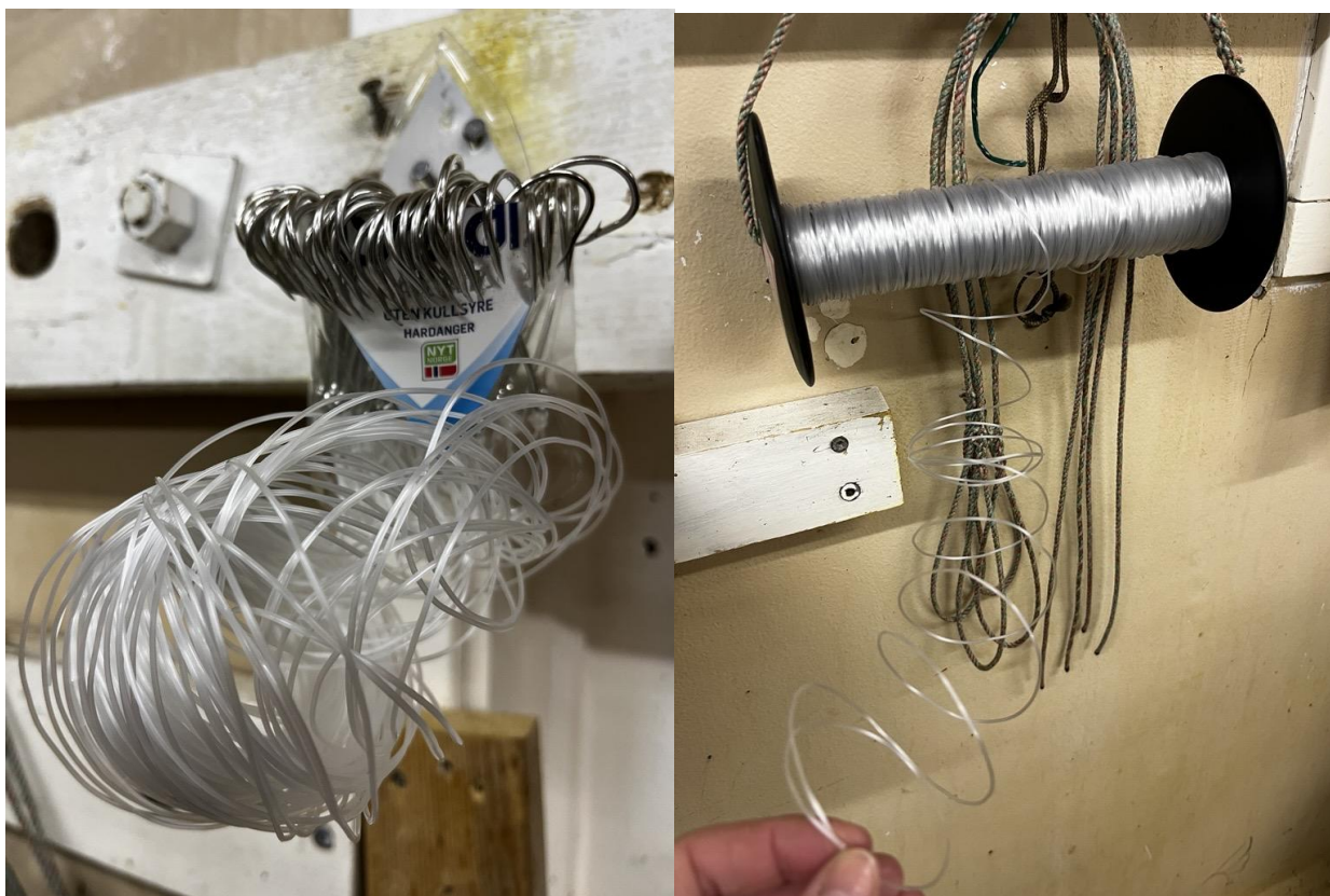
Bilde 2: Knytning av PBSA-forsyn (venstre). Legg merke til krøll på monofilament, forårsaket av stivt materiale på små spoler (høyre).
