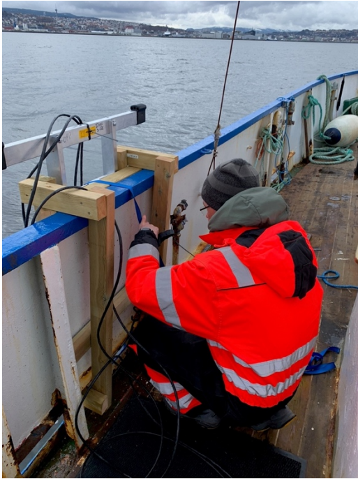
Test av feste for mobil PingMe enhet ombord på Harry Borten i Trondheimsfjorden.
