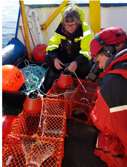
Test av PingMe transponder på Hummerteiner i Trondheimsfjorden.
