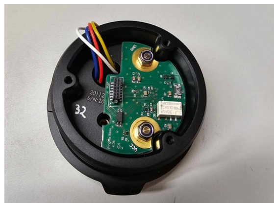
Montering av kretskort i transponder.
