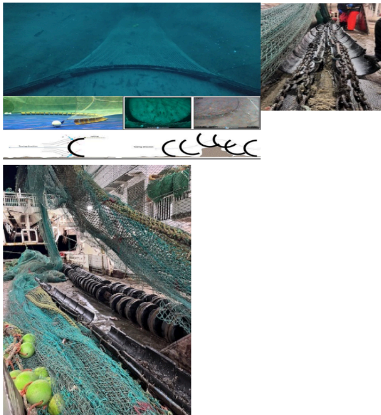
Figur.8 Bildet viser semisirkelgearet påmontert trål. Bildet til høyre viser semisirkelgiret til venstre i bildet mot rockhoppergiret til høyre. Foto: Jesse Brinkhof, Eduardo Grimaldo, Hermann Pettersen
