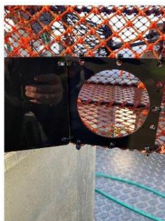
Figur 1. T.v. Skisse av lukeløsning som rømmingshull. T.h. Eksempel på innmontert lukeløsning med hengsel til venstre.
