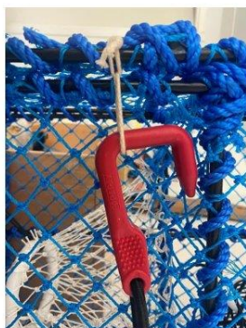
Figur 3. T.v. Låsekroken hukes i løkke av bomullstråd. T.h. Bomullstråd mellom strikk og krok.
