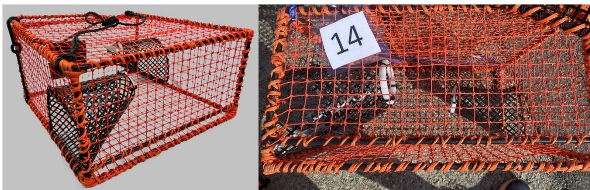
Figur 7.2 Fluktåpning som spalte ved bunnrammen.
