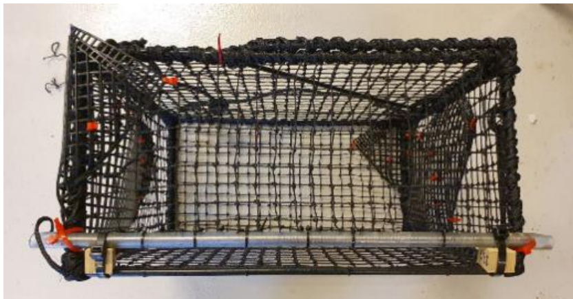
Figur 3.22 Krepseteine med modifisert fluktåpning.
