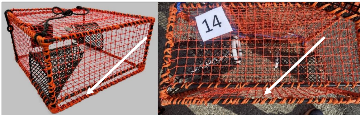
Figur 2.3 Hvit pil viser fluktåpning som spalte ved bunnrammen (Foto: Kristian L. Skaar).
