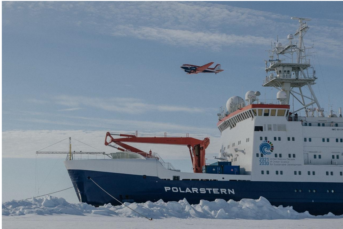
Abb. 1.0.5 Das Polarflugzeug Polar 6 fliegt am 22. Juli 2025 über die Eisstation 3a. Der Flug ist Teil der Zusammenarbeit zwischen CONTRASTS und den IceBird-Sommerkampagne 2025. Das Flugzeug schleppt den EM-Bird für Messungen der Meereisdicke (siehe Kapitel 2.9). (Foto: Evgenii Salganik)
