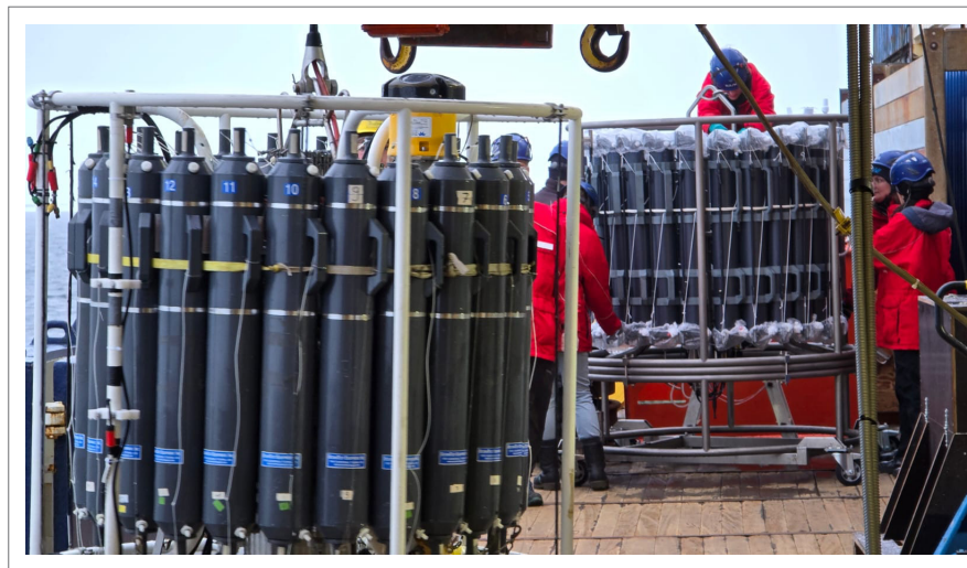
Abb. 1.4: Foto beider auf PS144 genutzten CTD/Rosetten-Systeme. Das “reguläre” System (links) und das spurenmetallreine System mit “Badehauben” zum Schutz vor Kontamination (rechts). Foto: Walter Geibert
