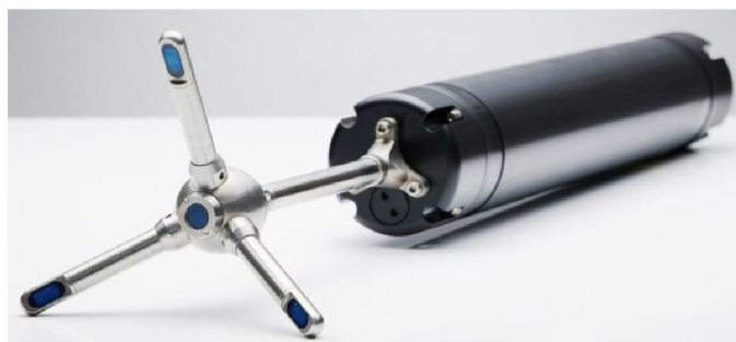
Figur 10 Hastighetsmåler fra Nortek; Vector – 300 m /2/
