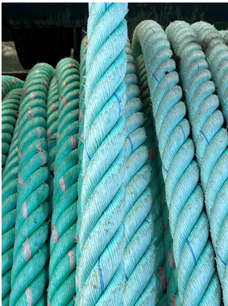
Bilde 5. BB arm etter 21 hal på blåkkeita, tauet er minimalt slitt.
