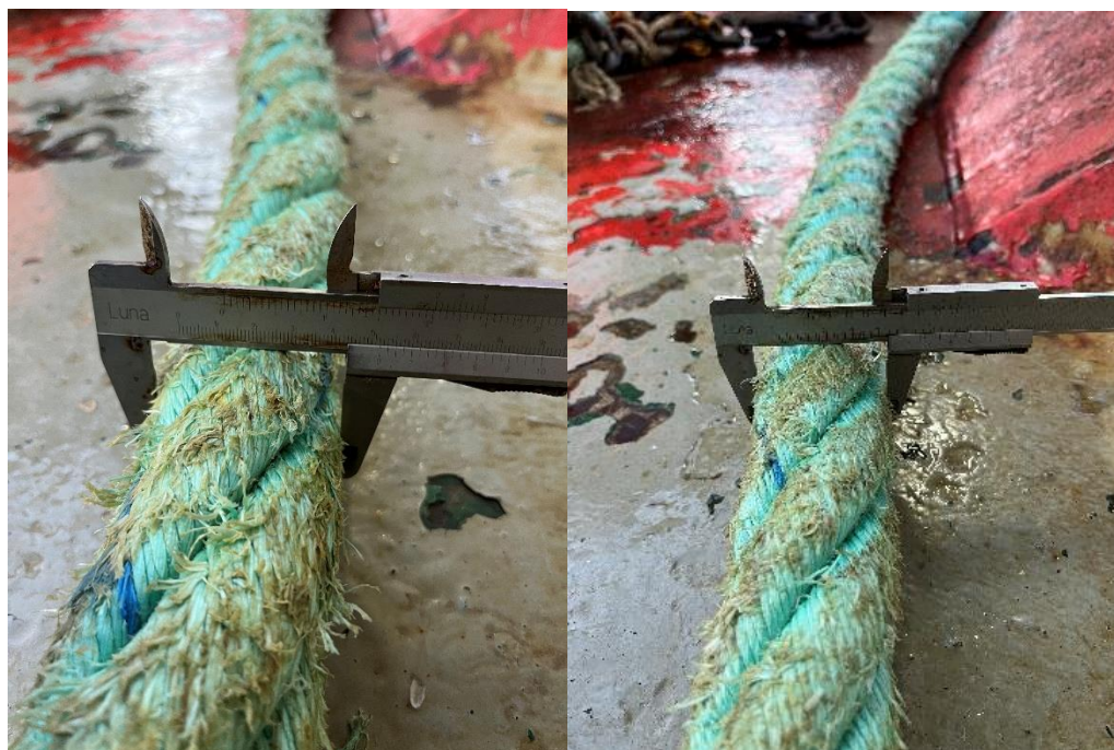
Bilde 6. STB arm 2, målt 19. november 2024, viser en tykkelse på 51-52 mm.
