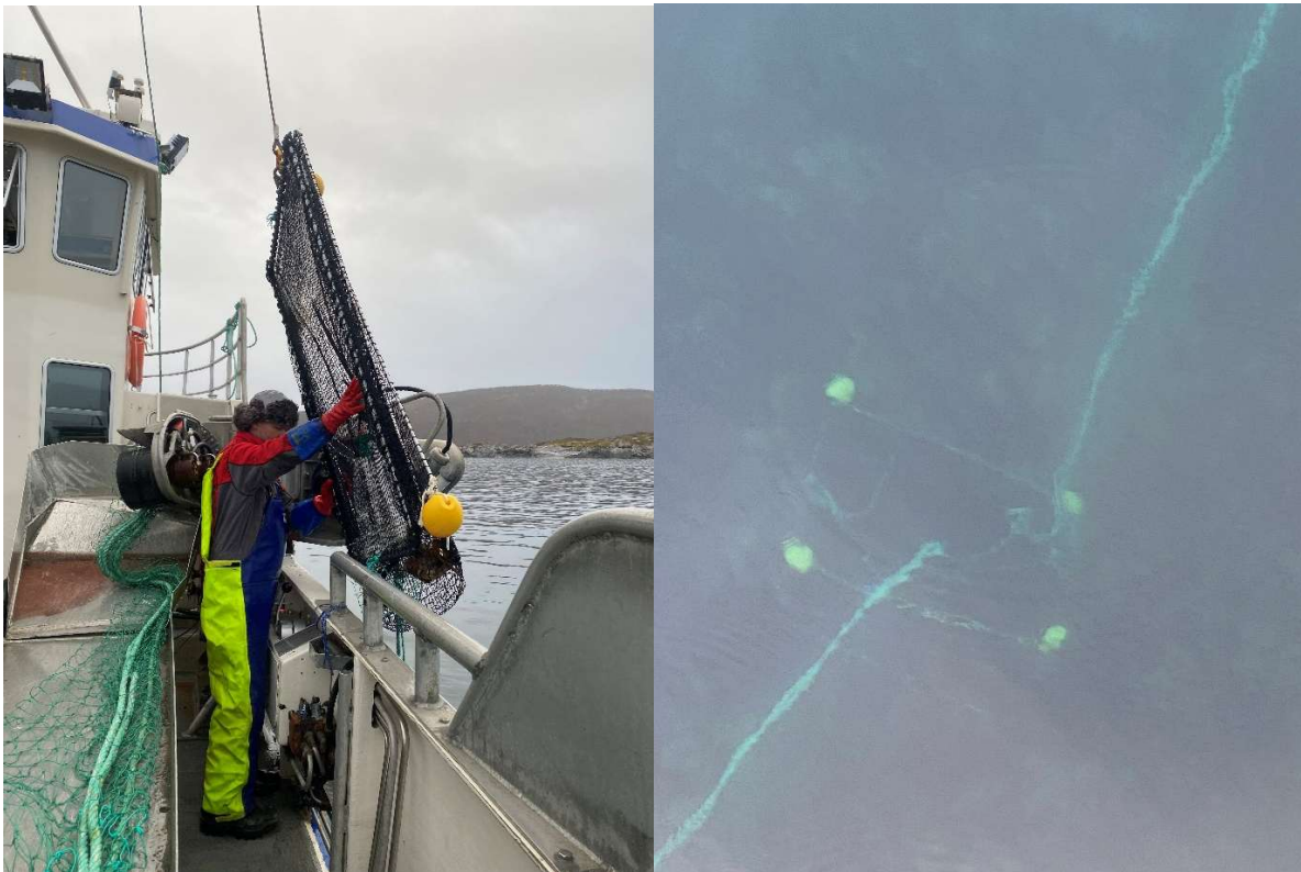
Bilde 4. Den første prototypen i bruk. Til venstre, første testhaling, til høyre viser hvordan redskapet ble satt på grunt vann for å kunne se hvordan det stod i havet. (Foto: Jørgen Vollstad, SINTEF Ocean)
