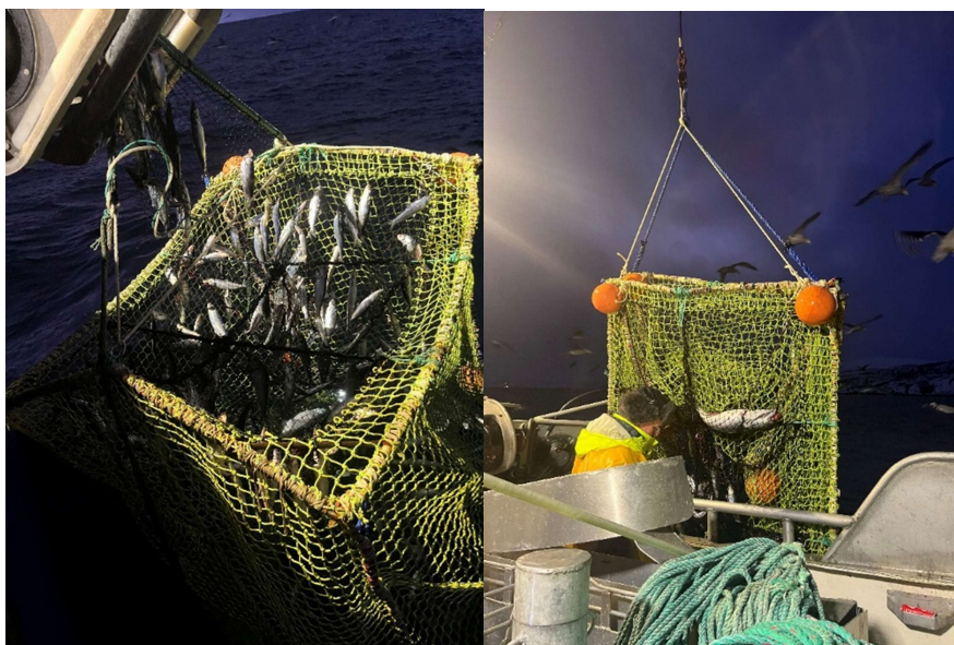
Bilde 15. Til venstre, silda har kledd kalvene pga kameralys. Til høyre, fangstenheten heises inn, en stor sei er gått inn. (Foto: Jørgen Vollstad, SINTEF Ocean)
