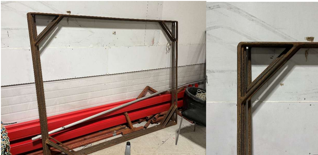
Bilde 6. Rammene av rundstål før det ble montert lin. (Foto: Jørgen Vollstad, SINTEF Ocean)
