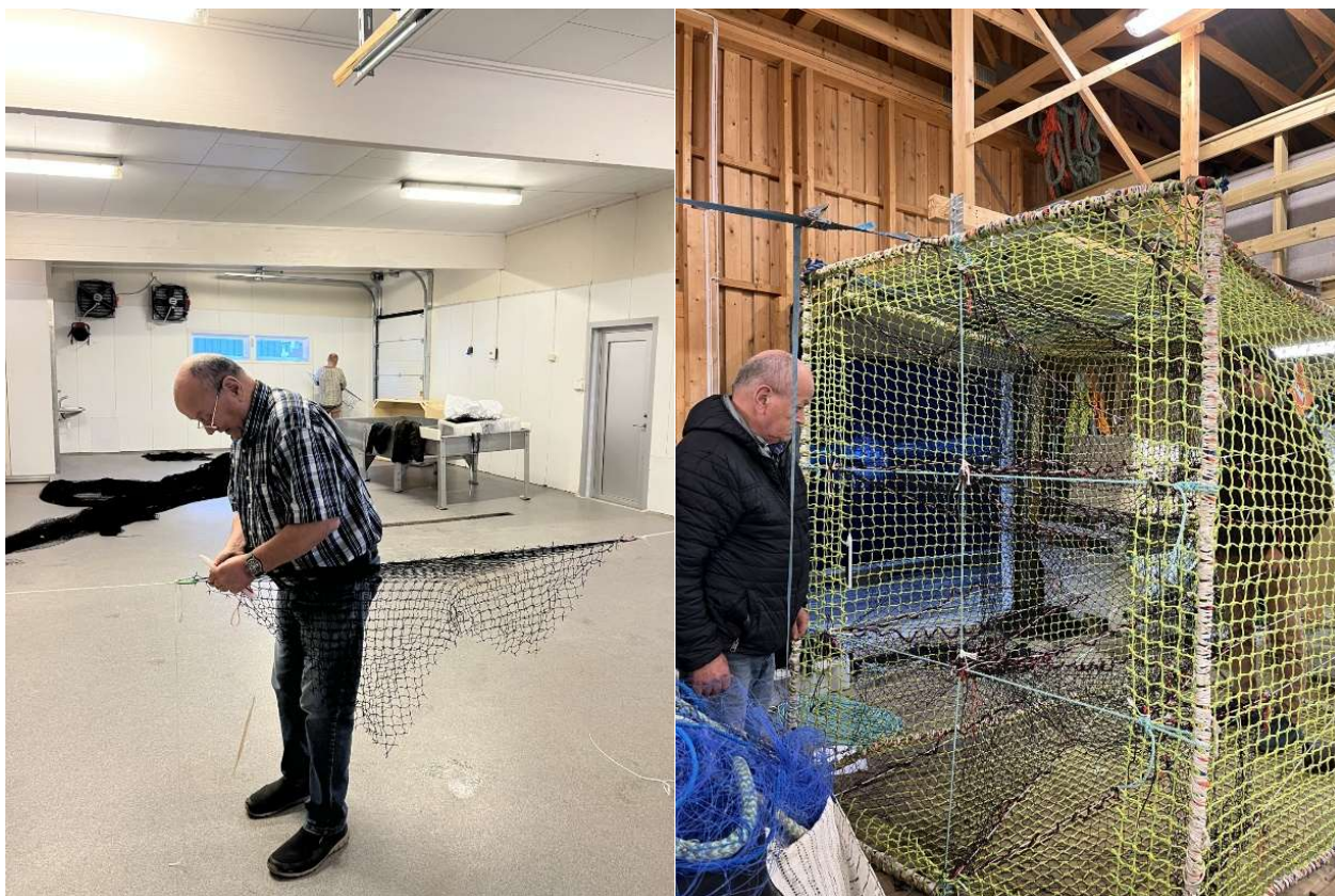
Bilde 8. Fangstenhetene er spent opp og sying av kalver og montering av disse er startet. (Foto: Jørgen Vollstad, SINTEF Ocean)
