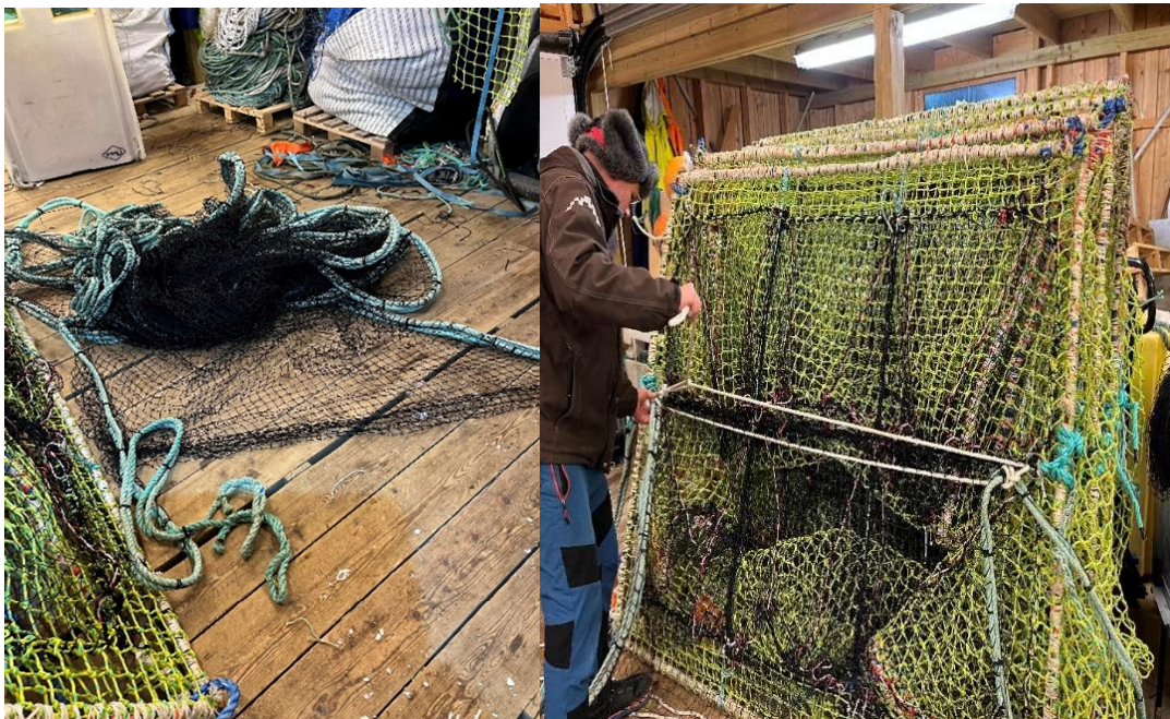
Bilde 11. Til venstre ledegarn i seinotlin med snudde masker, dobbel 12 mm bly og tripple flytetelner, til høyre ledegarn monteres til fangstenhetene, det hvite nylonauet er stroppen som løsner fangstenheten fra ledegarnet. (Foto: Jørgen Vollstad, SINTEF Ocean)
