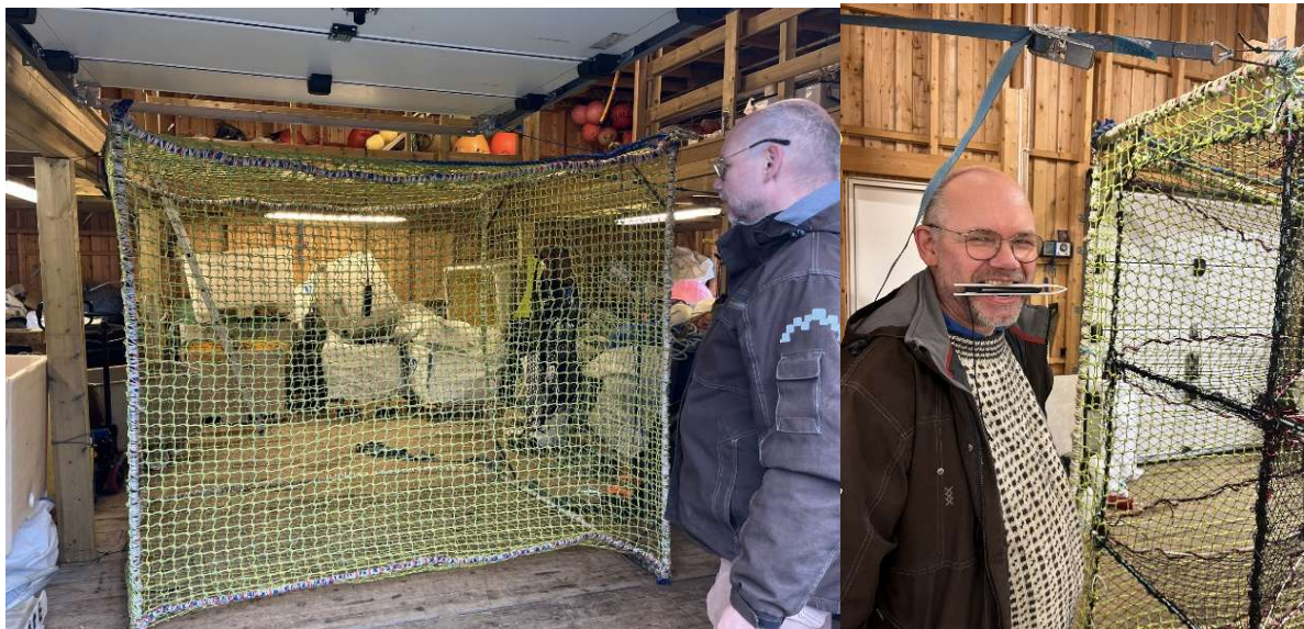
Bilde 8. Fangstenhetene er spent opp og sying av kalver og montering av disse er startet. (Foto: Jørgen Vollstad, SINTEF Ocean)
