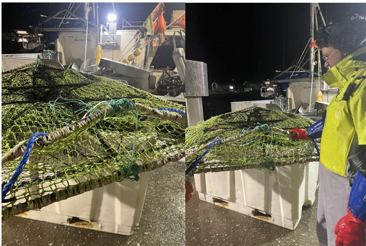
Bilde 16. Belastningen ble så stor at rammene ble bøyd på midten. (Foto: Jørgen Vollstad, SINTEF Ocean)
