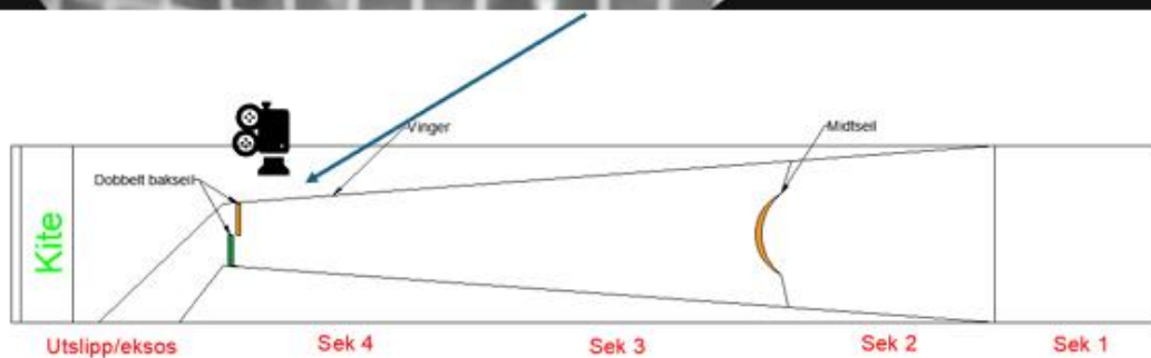
Figur 21: Småfisk passer gjennom 40x40 mm masker i seleksjonspanel mens storfisk blir igjen inne i seleksjonspanel og guidet mot utslipp.
