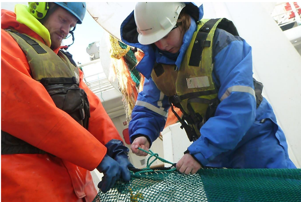
Figur 6: Spaltene for tilgang inn i Excluder ble lukket ved å hekle en tråd gjennom løkkesau.
