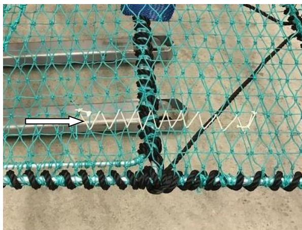
Figur 2. Sammenlisset rømmingshull i nedre del av kalven.
