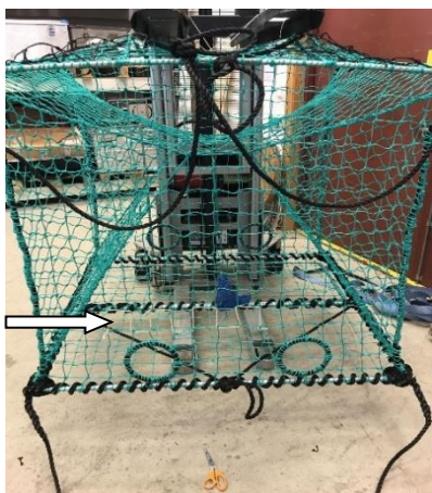
Figur 1. Rømmingshull montert i trekkretning av teinen.
