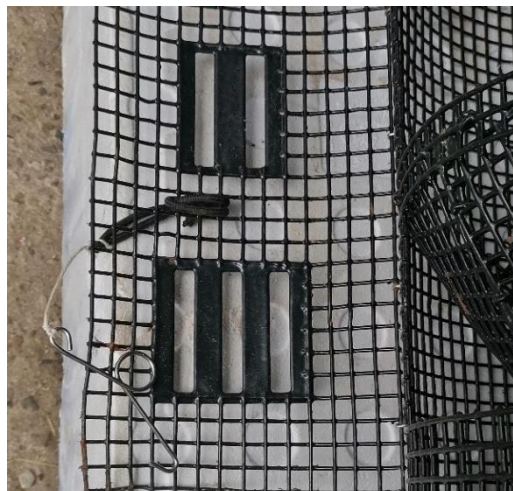
Figur 6. Bomullstråd monterert mellom strikk og krok.
