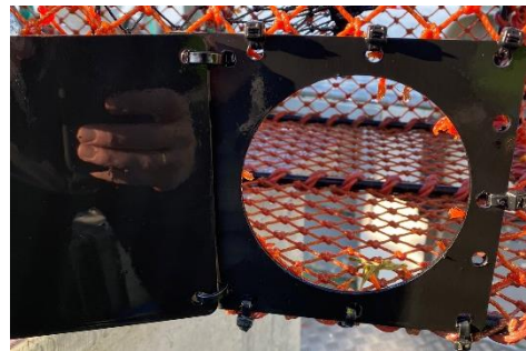
Figur 4. Eksempel på separat lukeløsning med hengsel. På bildet er luken åpen og hengslet til den ene siden. Luken festes med bomullstråd før fiske.
