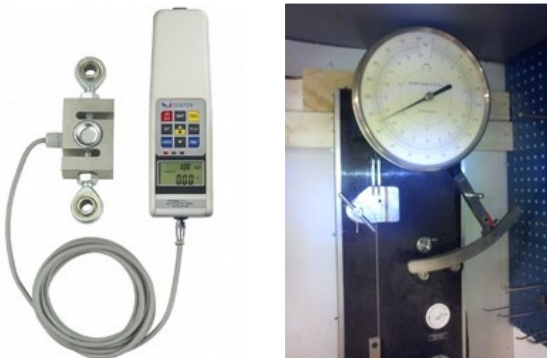
Figur 2. Måleapparatene brukt for testing av bruddstyrke med den digitale strekkcella til venstre og strekkbenken til høyrehøyre.
