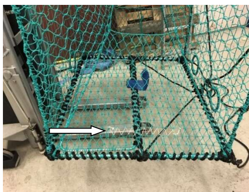
Figur 2. Sammenlisset rømmingshull i nedre del av kalven.
