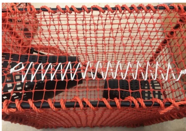
Figur 1. Snittet lisses sammen med bomullstråd. Bomullstråden skal kun knyttes i endene.
