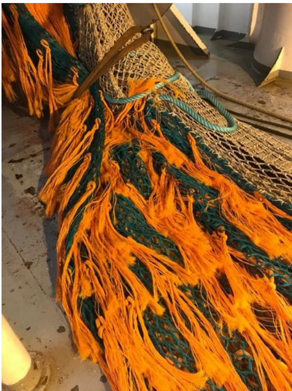
Figur 3-4 Beskyttelseskonstruksjon kalt «labbetuss» (dolly ropes) fra industritrål. Foto: Fiskeridirektoratet
