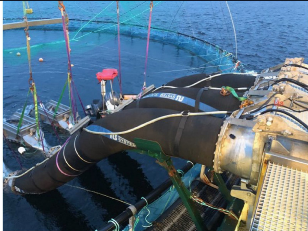
Figur 1. Biletet viser losseslangane til eit avlusingsfartøy. Det er montert silkasser i enden på slangane. Foto: Selskapet.
