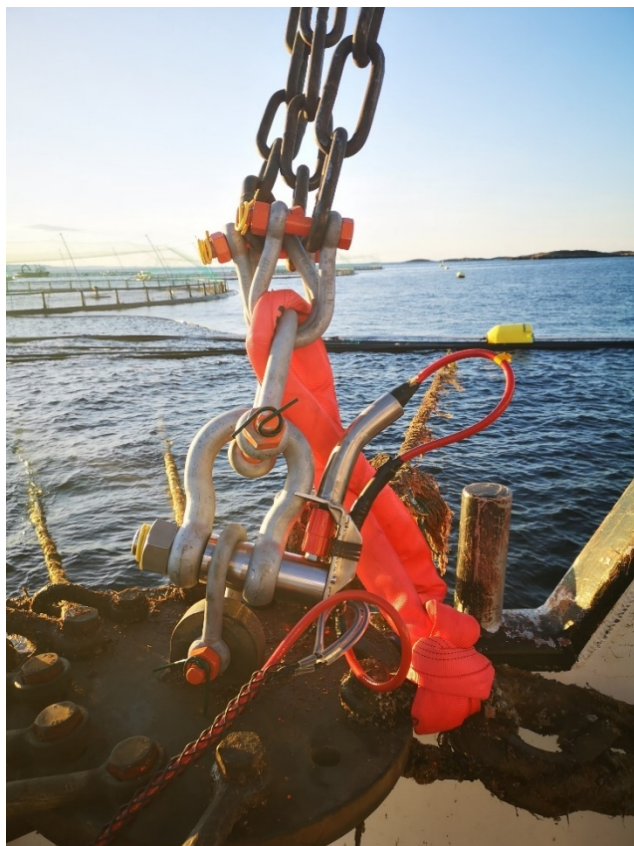
Figur 10 Lastsjakkell monterert mellom koblingsplate og bøye
