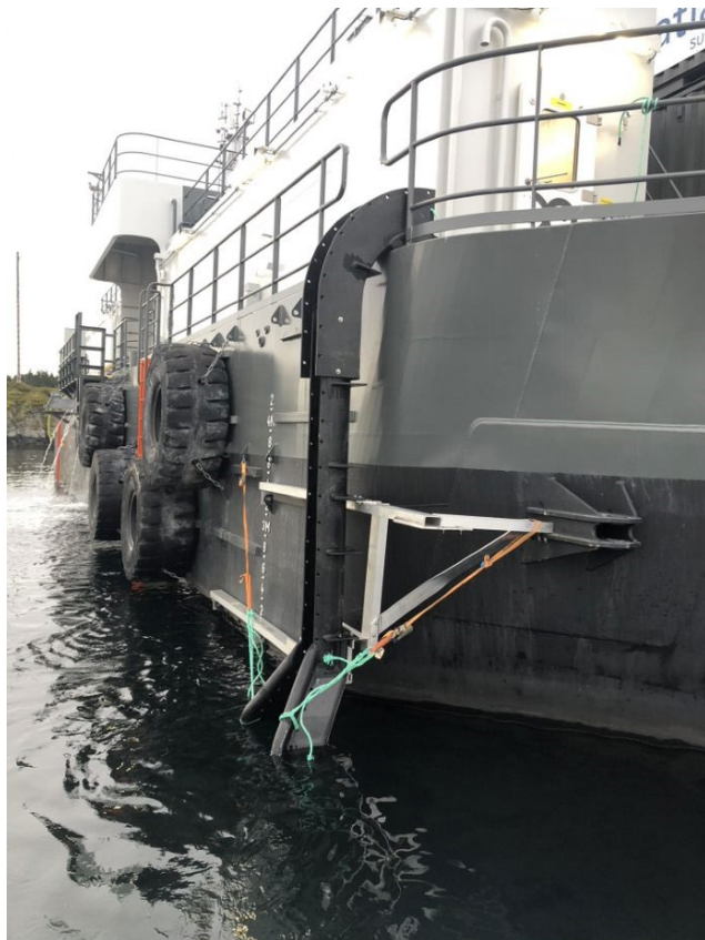
Figur 2 Krybbe for kabelføring fra flåte til sjø, samt containerløsning for utstyr på flåte
