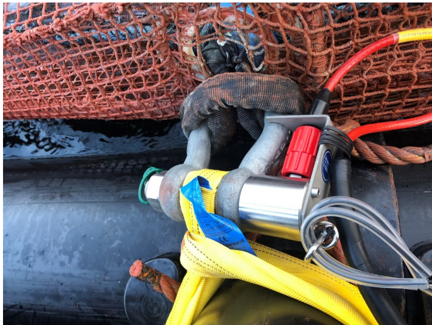
Figur 9 Lastsjakkell monterert på innfestingsløkke i tak
