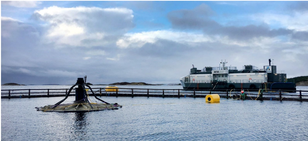
Figur 1 Nedsenkbar merd med flåte, container og styring
