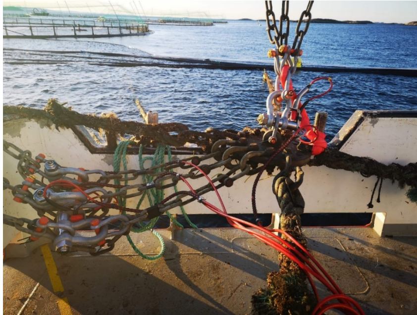
Figur 7 Lastsjakkell monteret i overkant av koblingsplate
