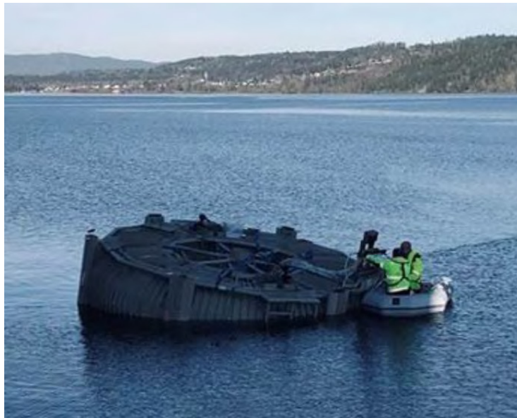
Figur 98: Krengeprøve ifm. utvidet testing hos Bluegreen Fusion
