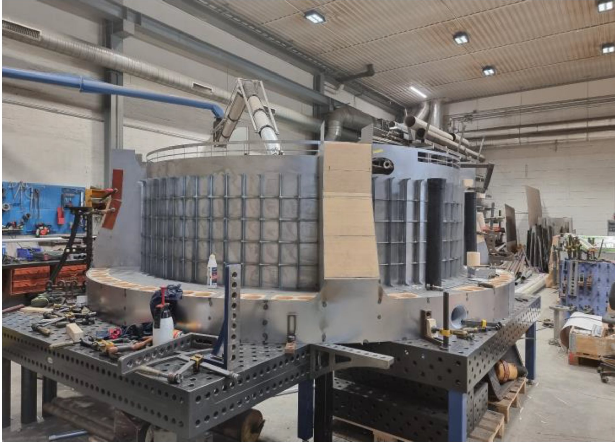
Figur 4. Modellbygging - stålramme og fylling av hardt plastskummateriale.
