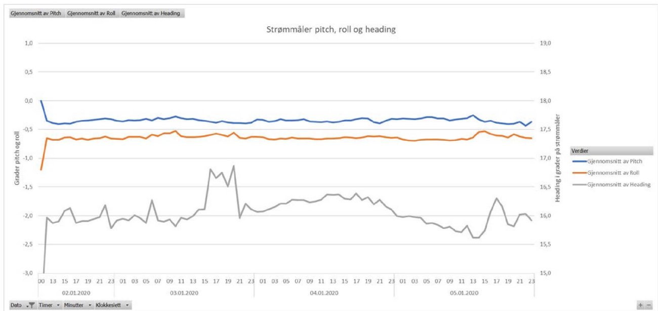
Figur 18 Måling av pitch, roll og heading i strømmåler montert på luftkuppel.
