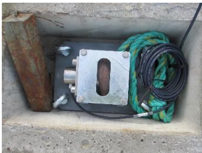
Bildet viser et eksempel på sensorer. Her en monterings- anvisningen for en last celle for forankring til venstre og faktisk montasje til høyre.
