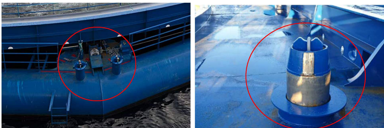
Figur 5 Kombinert fortøyningspunkt og pullert AG1 og AG2 (høyre bilde)
