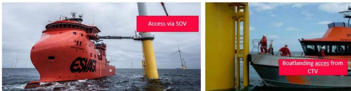
Figur 4-12 Servicefartøy: Service operating vessel (SOV, venstre) og crew transfer vessel (CTV, høyre), (Equinor, 2019)
