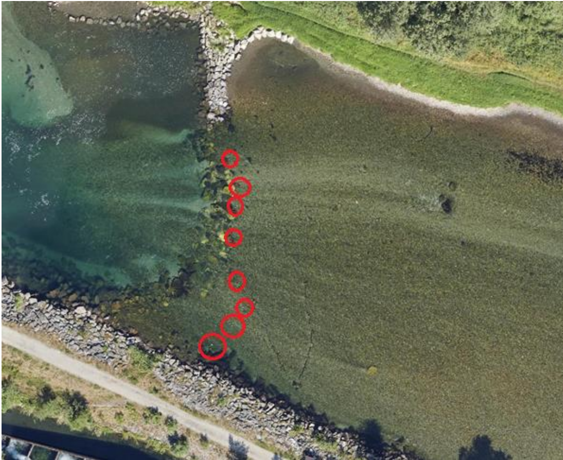
Figur 3. Plassering av åtte undervannskameraer (røde sirkler) i et tverrsnitt av Lærdalselvi i grensen mellom fersk- og saltvann. Kulpene i den kunstige trapp/fossen i Villakssenteret er synlige nederst i bildet.
