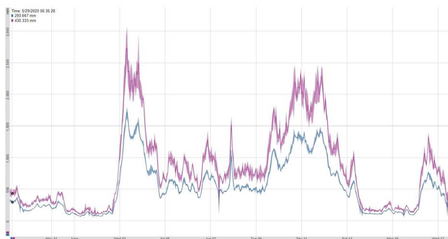
Figure 12. Bølgehøyde i perioden 31 mai. til 17. juni målt med ADCP bølgemåler montert på utsiden av merda. Den 3. juni (svarer til ekkogrammet over) var maksimal og signifikant bølgehøyde henholdsvis 3.1 m og 1.8 m.
