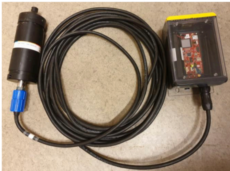
Figur 1. Lyttebøye (hydrofon) med tilhørende overflatemodul (til høyre). Foto: J. A. Alfredsen, NTNU.
